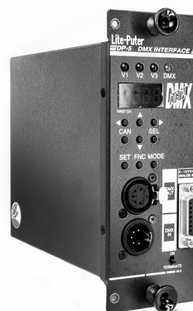
圖 8-6 控制模組 (Control Module)
